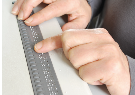
Eine Braillezeile erleichtert sehbehinderten Menschen die Arbeit am Computer.
